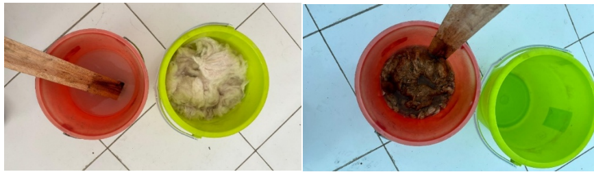
Gambar 4. 3 Proses perendaman dengan NaOH
