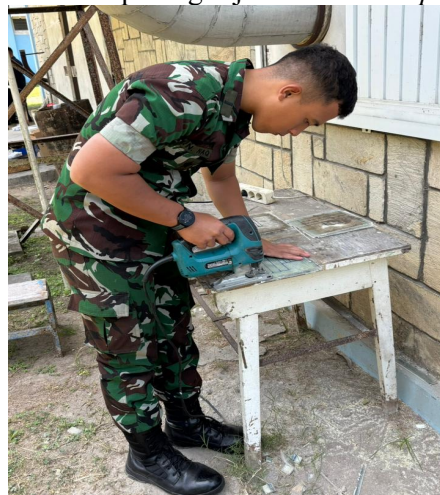
Gambar 4. 8 Proses pemotongan specimen
