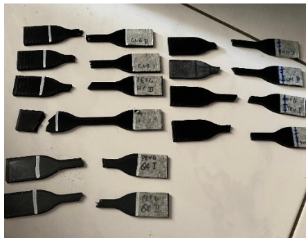
Gambar 8 Spesimen Uji Tarik Filamen PETG Setelah Melaksanakan Pengujian
