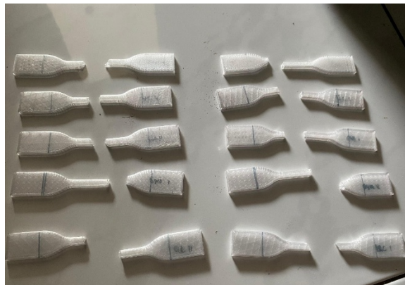
Gambar 7 Spesimen Uji Tarik Filamen Polycarbonate Setelah Melaksanakan Pengujian
