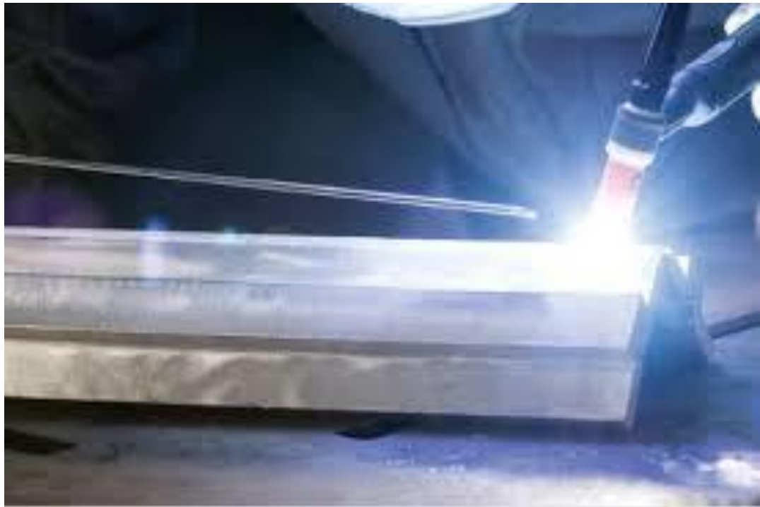
Gambar 2.2. Pengelasan pada aluminium
