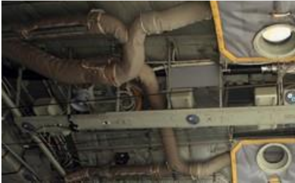
Gambar 2.1. Saluran ducting ac pada pesawat
