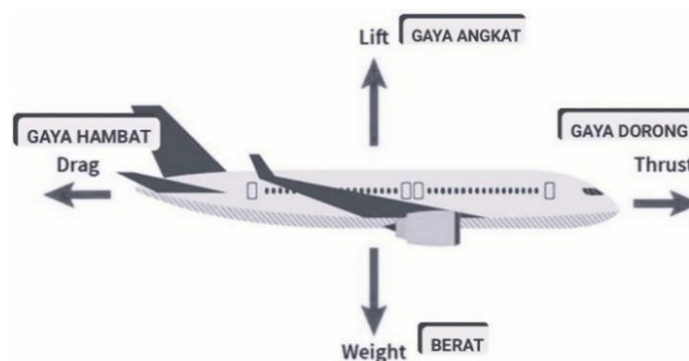
Gambar 1. Gaya-gaya yang bekerja pada pesawat terbang.
