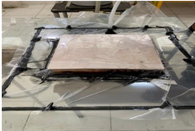
Gambar 1. Pembuatan vacuum bagging
